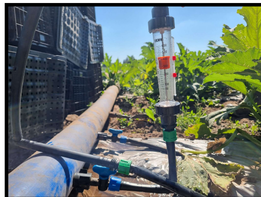
Fotografía 2: Flotómetro midiendo en cinta de riego.
