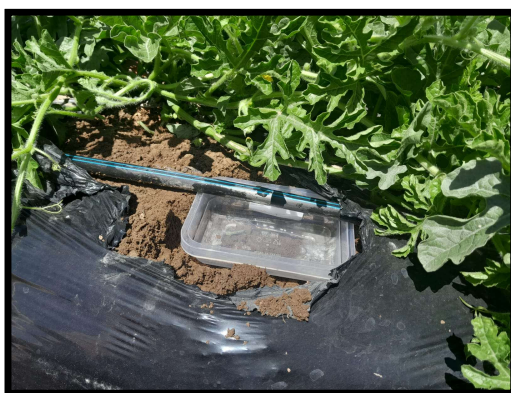
Fotografía 3: Prueba de aforo Aforo de cinta de riego
