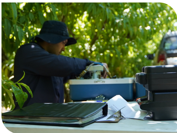
Figura 1: Medición de potencial hídrico mediante una cámara de presión tipo Scholander.
